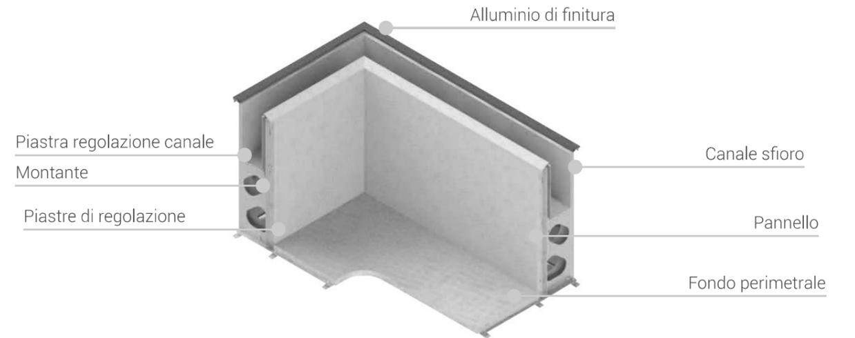
Sezione senza telaio
