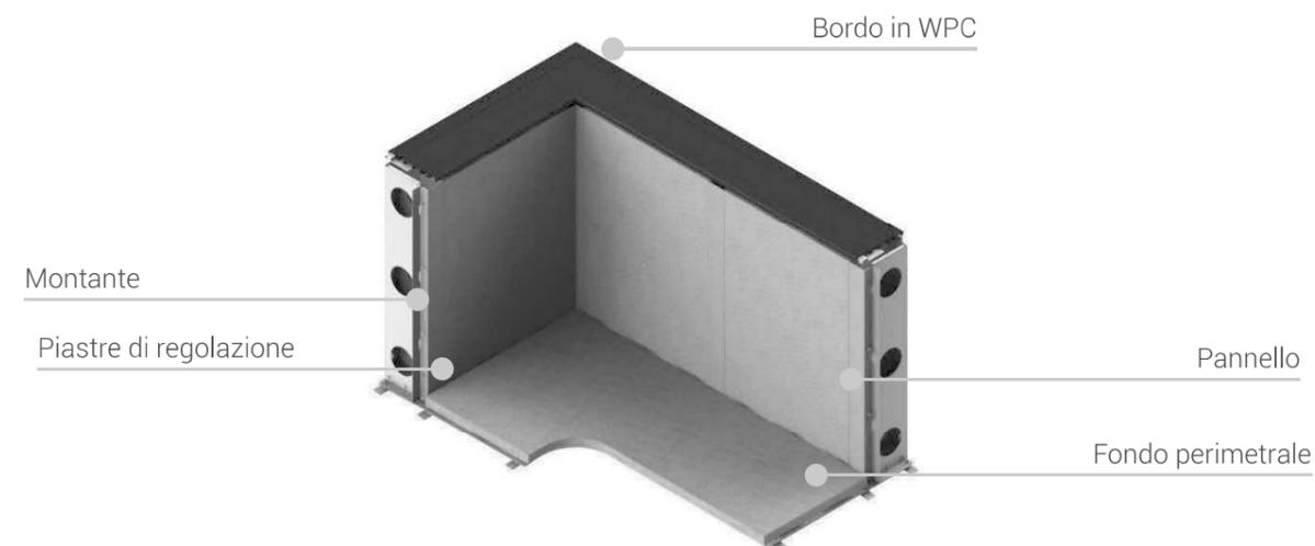
Sezione senza telaio
