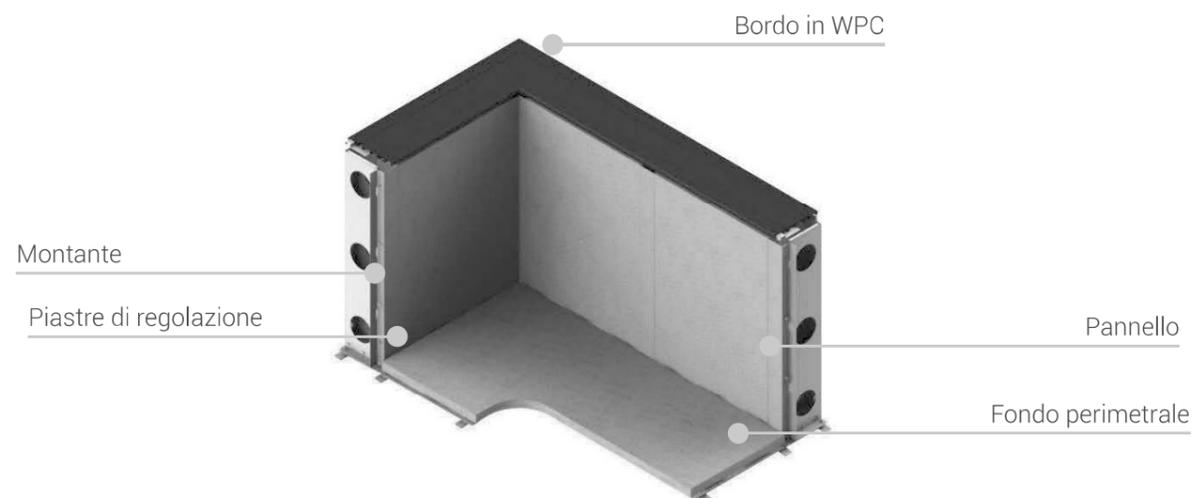
Sezione senza telaio
