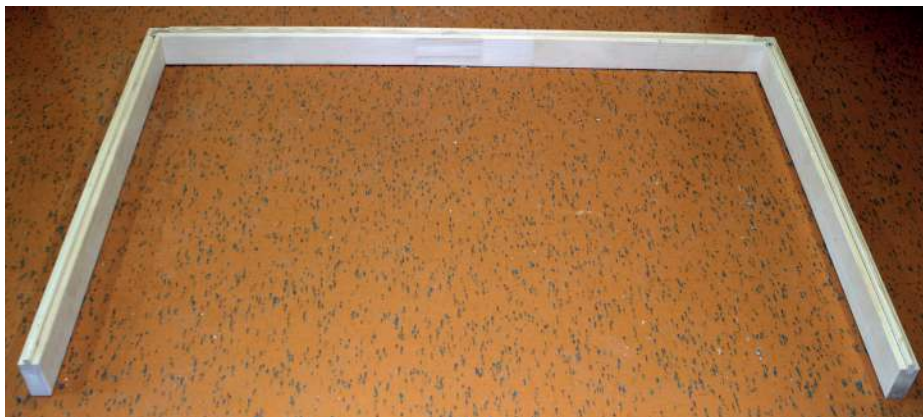
Afb. 1: Plaatsen van de drie bodemframe-elementen
