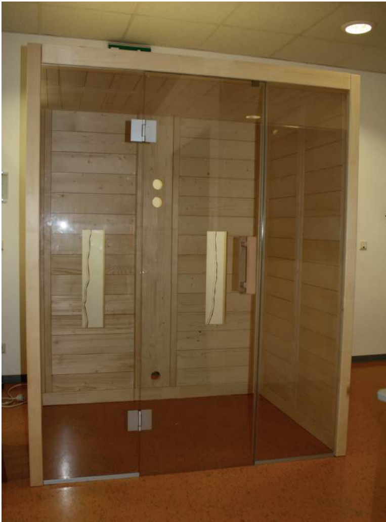
Abb. 26: Fertige Kabinenwände und Dachelemente
