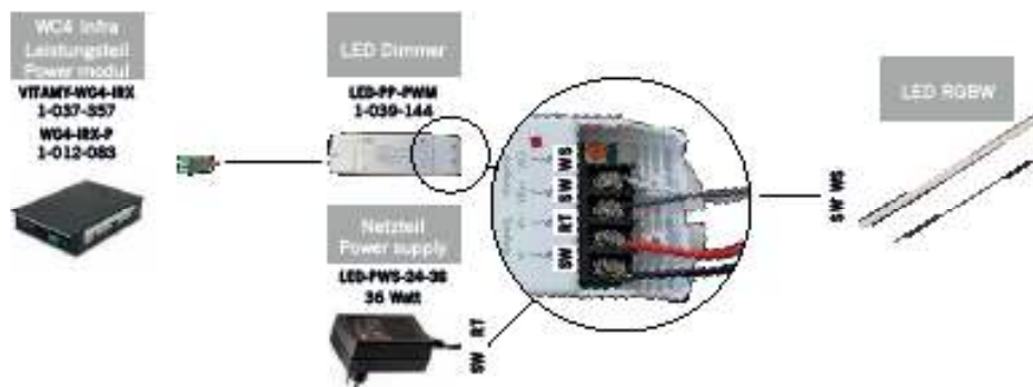
Abb. 27: Verbinden des LED RGBW mit der Steuerung
