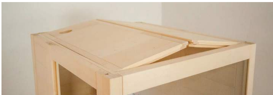
Abb. 15: Befestigen der Dachelemente
