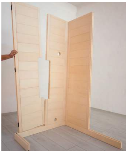
Fig. 6: Inserimento dell'elemento parete con intaglio
