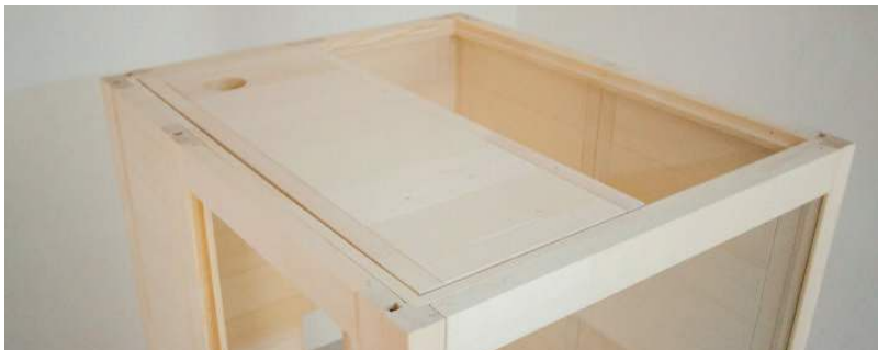
Afb. 14: Plaatsen van dakelementen voorzijde
