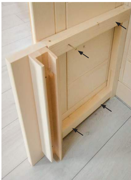
Fig. 18 : Monter les supports du banc
